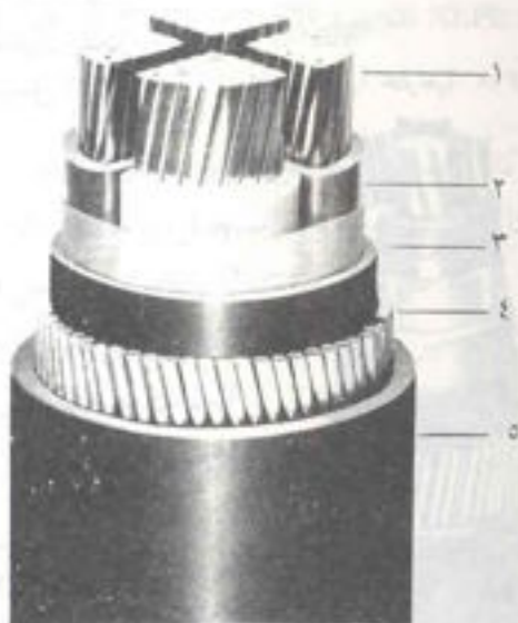
شكل ٤ - ٣ كابل ذو عازل PVC ١٠٠٠/٦٠٠ فولت مسلح بأربعة قلوب (حتى ٤٠٠ مم ٢ )
